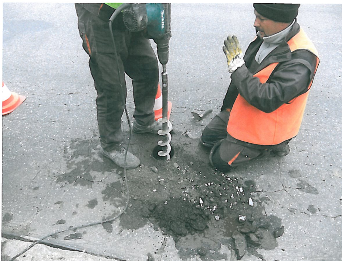
Fot . 12. Pobieranie próbki kruszywa ( miału ) z odkrywki Nr 8 w km 1+875
