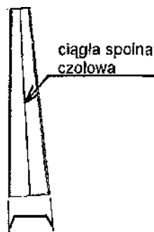
Rys. 8. Pały specjalne wykorzystywane do zniwelowania pochylenia cianki.
